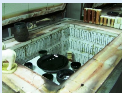
現在、工房ではこの電気窯(中・小型作品用)とガス窯(大型作品用)を使用
